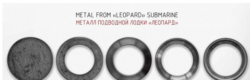
Les différentes étapes de fabrication de la lunette de la montre à partir d'une pièce du Léopard.
