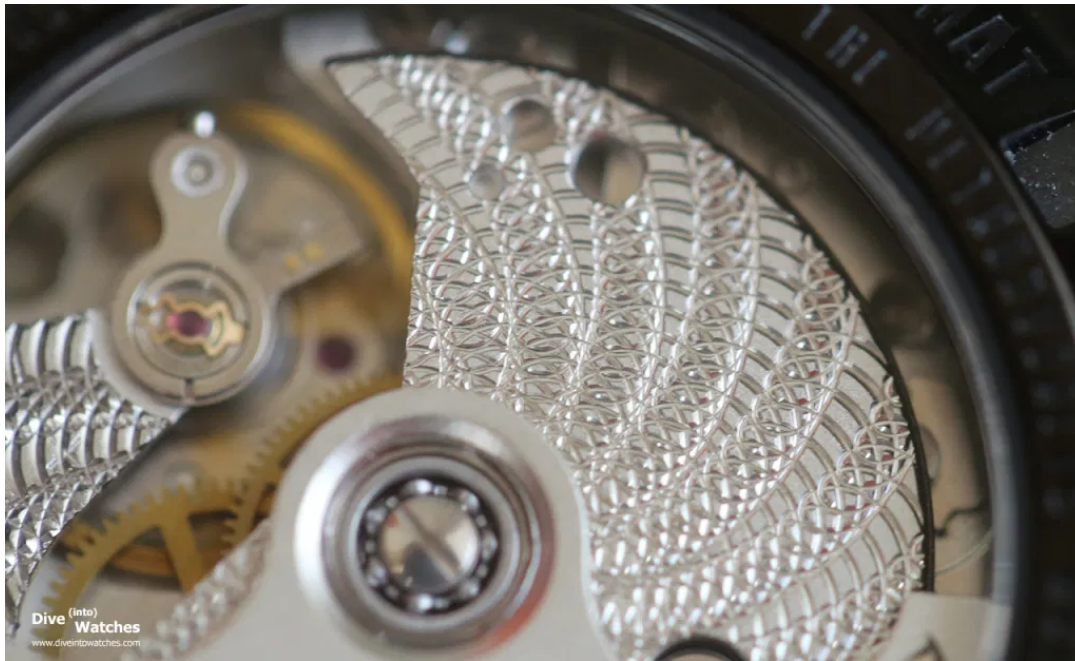
Das Inhouse-Kaliber 2615 mit rund 40 Stunden Gangreserve und „Omega“ Wellendekor.
